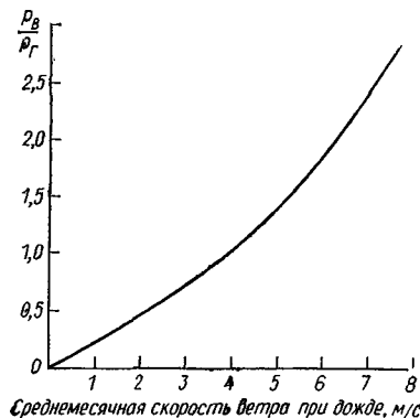
Рис. 9. График зависимости соотношения количества вертикальных и горизонтальных осадков \frac{P_v}{P_g} от среднемесячной скорости ветра при дожде
