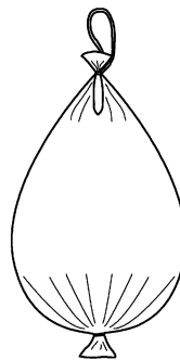
Рисунок Е.3 – Основание, образованное сужением оболочки
