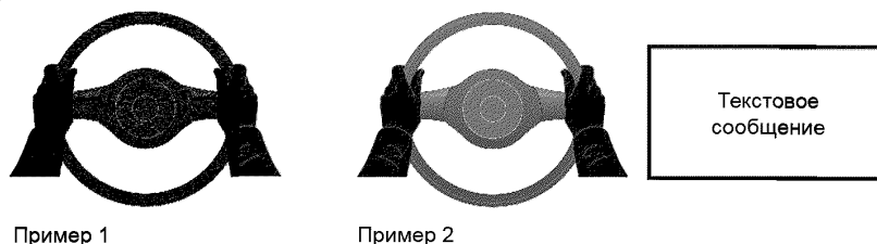
Рисунок 1 — Примеры оптического сигнала предупреждения
