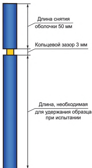
Рисунок 30 — Разделка испытуемого образца ОК
