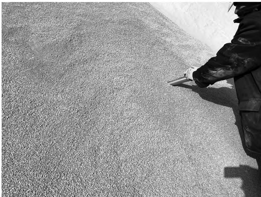
Рисунок 9 — Отбор точечных проб песка пробоотборной трубкой
