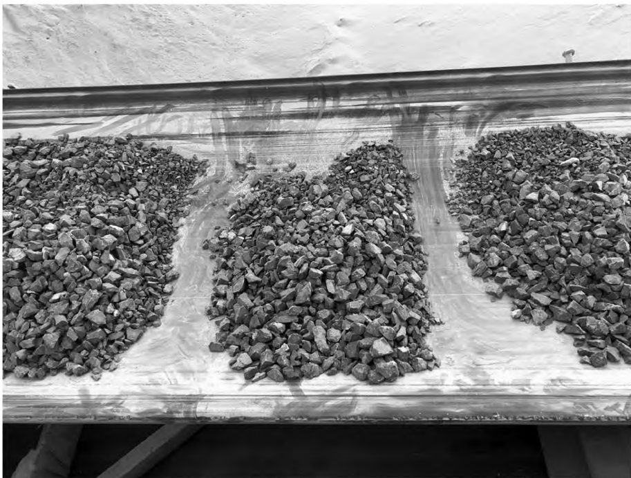
Рисунок 4 — Отбор точечной пробы без применения пробоотборной рамы
