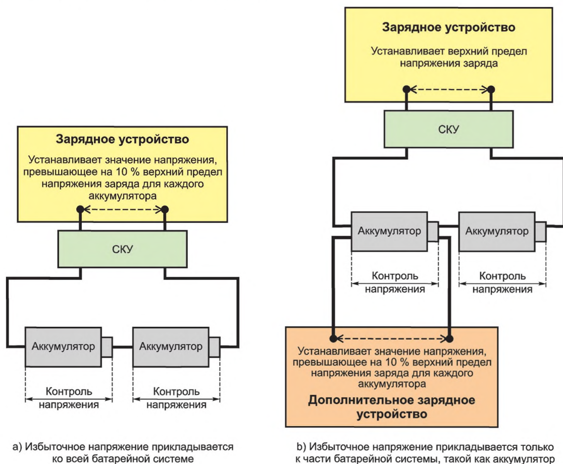
Рисунок 6 — Пример конфигурации схемы управления напряжением при перезаряде
