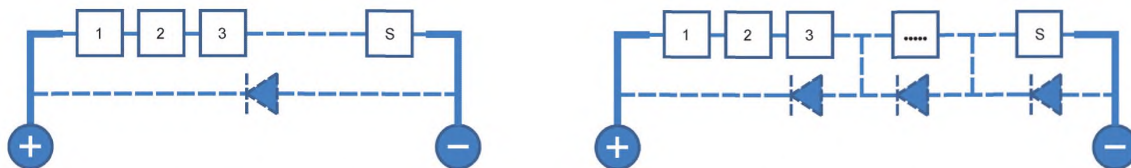
Рисунок 2 — Последовательное соединение фотоэлектрических элементов, защищаемое одним или тремя шунтирующими диодами
