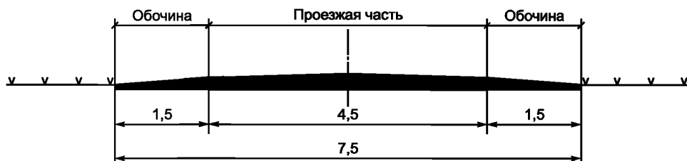
б) Типовой поперечный профиль проездов
