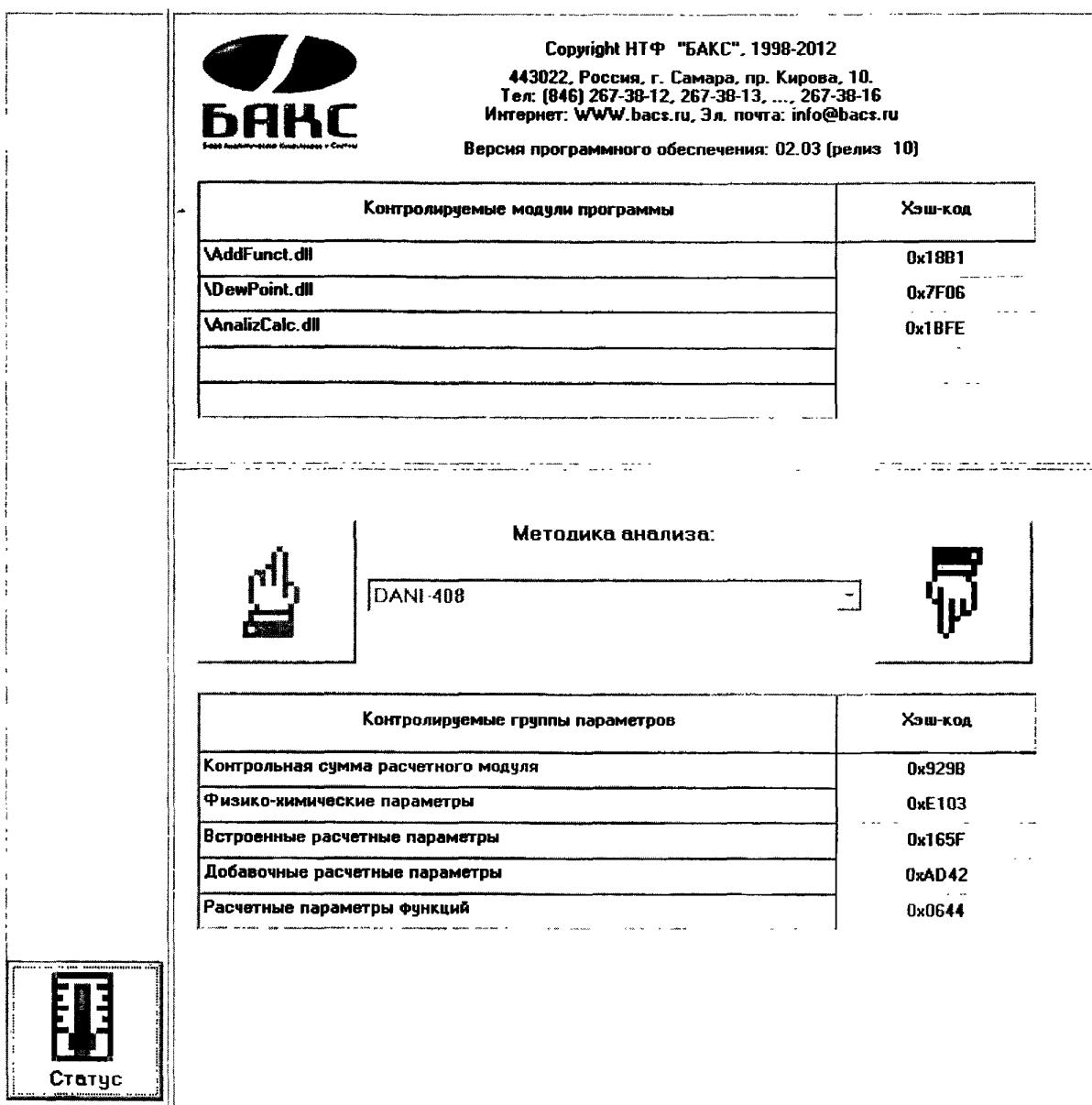
Считают, что хроматограф выдержал поверку по п.6.3, если в нижней таблице приведенный перечень CRC-кодов контролируемых блоков настроек для выбранной методики анализа (аналитической задачи) соответствует номерам (цифрам), указанным в разделе «Программное обеспечение» описания типа.
