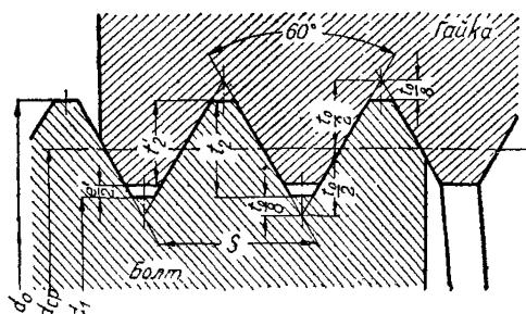
Пример обозначения метрической 3-й мелкой резьбы диам. 64 мм (шаг 2 мм)
