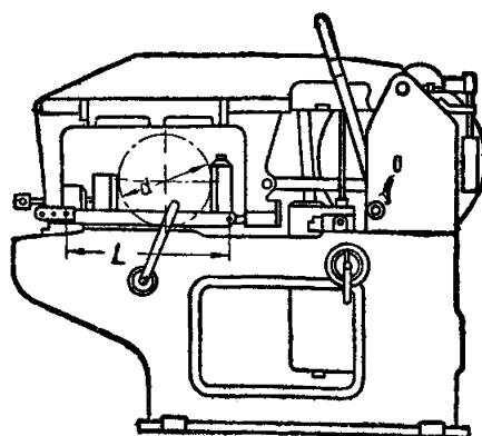
Наибольший диаметр разрезаемого материала  $d$  (мм)... 150 250
