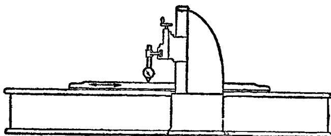
**Технические условия.** Рабочая поверхность стола при движении должна быть параллельна своим направляющим в вертикальной плоскости.
