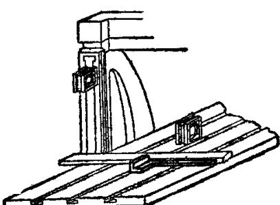
**Технические условия.** Для станков с двумя стойками: передние грани стоек должны находиться в плоскости, перпендикулярной движению стола.
