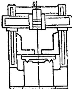
**Технические условия.** Стойки должны быть перпендикулярны к поверхности стола в плоскости, перпендикулярной к его движению. Для станков с одной стойкой допускается наклон верхнего конца стойки только к столу.
