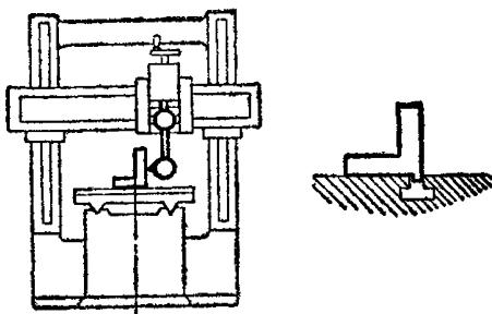
**Технические условия.** Пазы стола должны быть параллельны направлению движения стола.
