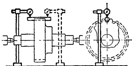
**Допускаемые отклонения при диаметре делительной окружности**
