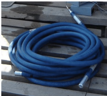
Рисунок 10 - Массив инклинометрических датчиков в форме гибкой сборки
