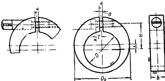
Пример обозначения зажимного кольца № 2 для трубчатых прогонок с резьбой Внврота от  $\frac{1}{4}$ " до  $\frac{5}{8}$ ".
