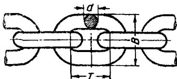
С б значение цепи с диаметром  $d=20$  мм.ЦЕПЬ КАЛИБРОВАННАЯ 20
