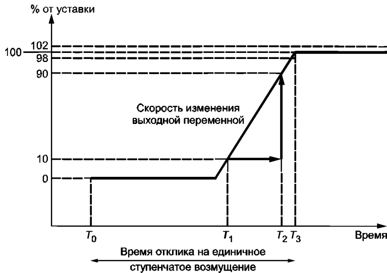
Рисунок 5 — Время отклика на единичное ступенчатое возмущение и скорость изменения выходной переменной СНЭЭ
