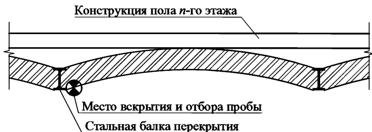
Рисунок 23 – Схема вскрытия и отбора пробы кирпичной кладки из сводов
