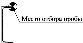
Рисунок 32 – Схема отбора пробы из стальной балки, изготовленной из швеллера
