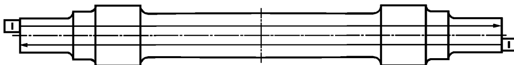
Рисунок 5.1 — Схема Т1 УЗК структуры металла черновых осей
