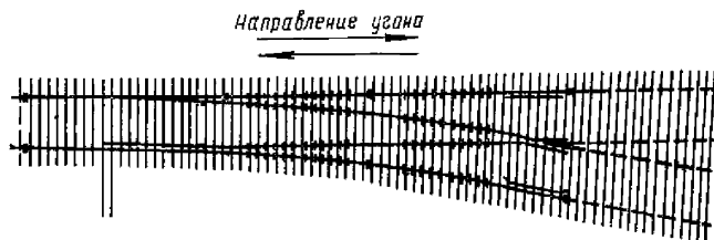
Рис. 48. Схемы расположения пружинных и самозаклинивающих противоугонов при двухстороннем уgone
