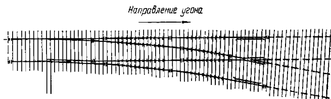
Рис. 47. Схема расположения пружинных и самозаклинивающих противоугонов при одностороннем уgone
