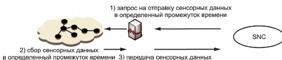
Рисунок 7 — Сбор сенсорных данных: режим pull — режим включения
