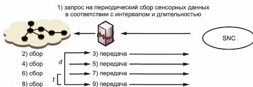
Рисунок 5 — Сбор сенсорных данных: режим pull — непрерывный режим
