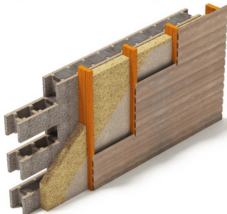
Рисунок М.27 – Вариант вентилируемого фасада наружной стены из блоков с несущим слоем из монолитного железобетона без утепляющих вкладышей с облицовкой сайдингом и слоем утеплителя
