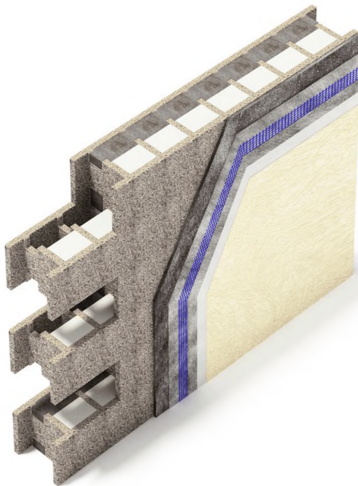
Рисунок М.28 – Вариант вентилируемого фасада наружной стены из блоков со слоями из минеральной ваты
