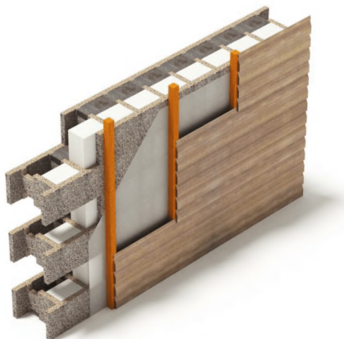
Рисунок М.26 – Вариант вентилируемого фасада наружной стены из блоков с утепляющими вкладышами с облицовкой сайдингом
