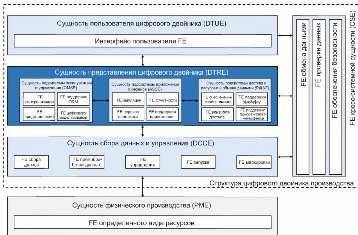
Рисунок 5 — Функциональное представление типовой архитектуры цифрового двойника производства, декомпозированное на функциональные сущности (FE)
