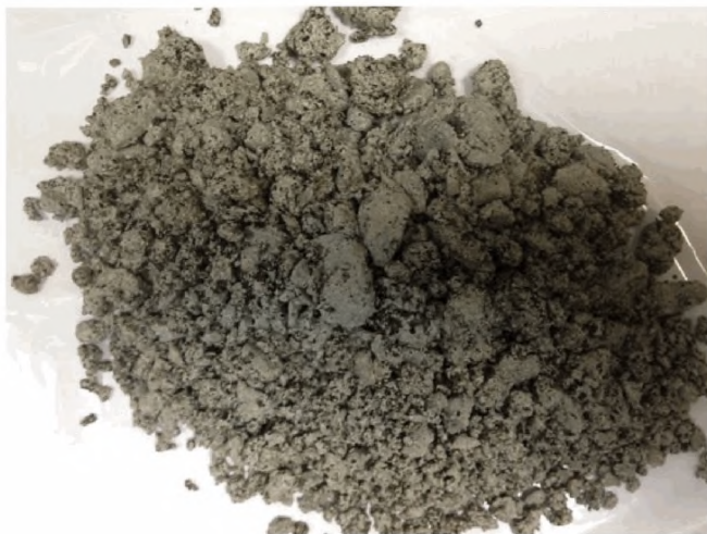
Рисунок А.1 – Смесь с битумной эмульсией не пригодной для приготовления органоминеральных смесей по показателю обволакиваемости
