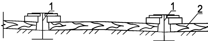
Рисунок 20.1 – Закладное крепление из металлических двутавровых свай
