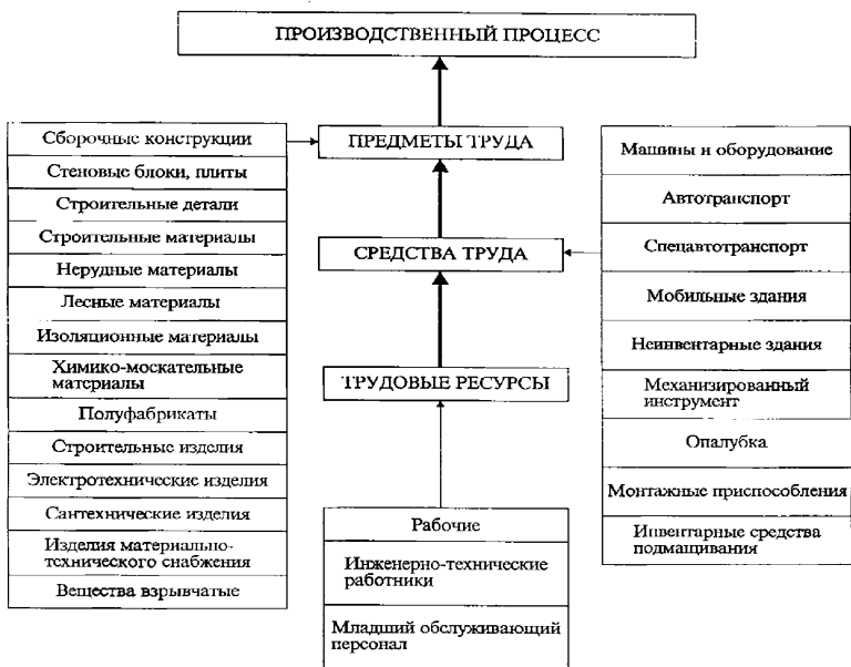
Рисунок 4.6 – Основные элементы и их взаимосвязи в строительной системе
