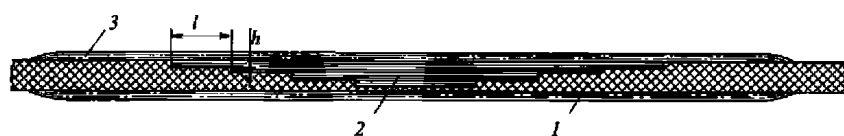
Рис. 2.6.2-1 Стыковое соединение со ступенчатой разделкой кромок: 1 — стенка сосуда; 2 — соединительные слои; 3 — расформовка; h — глубина ступени; l — ширина ступени
