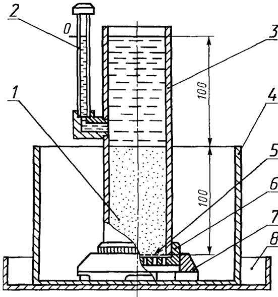
1 — образец; 2 — пьезометр; 3 — трубка;
