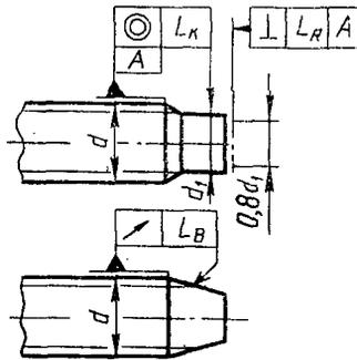
пункт 12. Наименование размера  $d_1$  изложить в новой редакции: «Диаметр гладкой части стержня, равный номинальному диаметру резьбы»;
