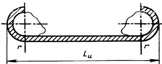
Расстояние  $rr$ , мм, равно утроенному шагу крутки;  $r$  — ограничивающие отметки для стандартного испытания;  $L_u$  — эффективная длина, измеренная без натяжения, испытуемый отрезок просто расправлен.
