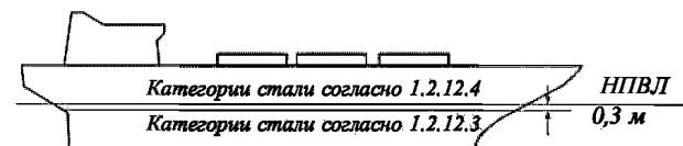
Рис. 1.2.12.3 Требования к категории стали для надводной и подводной части наружной обшивки
