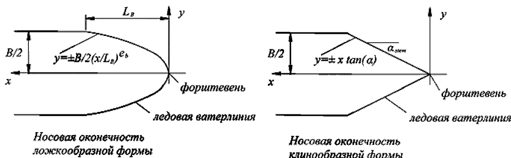
Рис. 1.2.13.2.1-1 Определение формы носовой оконечности
