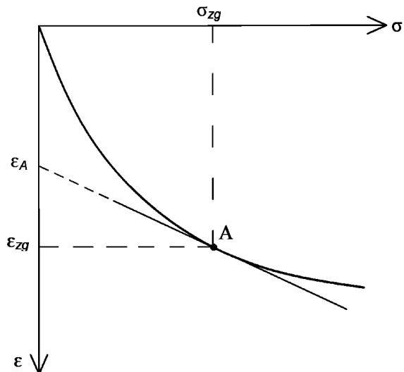
$\sigma$  — вертикальное напряжение, МПа;  $\epsilon$  — относительная деформация;  $\sigma_{zg}$  — природное вертикальное эффективное напряжение, МПа;  $\epsilon_A$  — условная величина относительной деформации, соответствующая точке пересечения касательной к компрессионной кривой в точке А с осью  $\epsilon$ ;  $\epsilon_{zg}$  — величина относительной деформации, соответствующая  $\sigma_{zg}$
