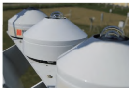
Рисунок 10 – Размещение на следящей системе пиргелиометра (слева), пиранометров и пиргеометра (справа)
