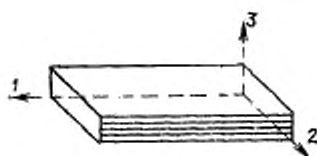
Рисунок 1 — Направление осей координат
