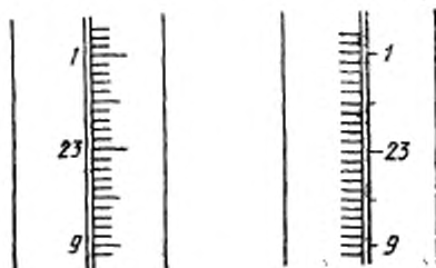
Рисунок 2 — Различные способы градуировки и оцифровки
