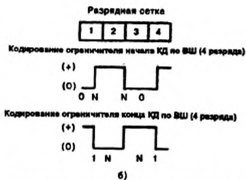
Рисунок 8 — Кодирование синхрореабулы и ограничителей начала и конца КД
