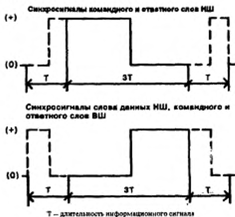
Рисунок 4 — Представленные синхросигналы слов, передаваемых по НШ, при использовании ВОСПР
