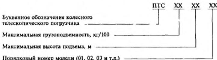
Пример условного обозначения погрузчика с телескопической стрелой с грузоподъемностью 2,5 т, высотой подъема 7 м, третьей модели:
