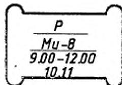
— район воздушной разведки с указанием вида разведки (Р — радиационная разведка), типа самолета (вертолета), времени и даты ведения
