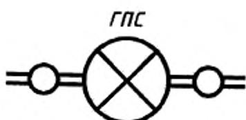
— газопровод с газокомпрессорной станцией
