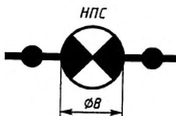
— нефтепровод с перекачивающей станцией
