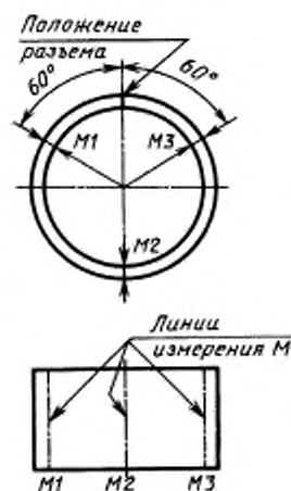
Рисунок 5 — Трехлинейная схема измерения для неразъемных или сварных втулок при D_0 \leq 150 мм
