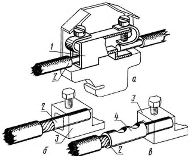
*a, б — однопроволочная (многопроволочная, сплавленная в монолит) жила; в — многопроволочная жила, оконцована кабельным наконечником*
