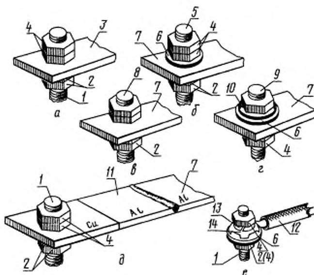
*a — проводник из меди, твердого алюминиевого сплава или алюминия с защитным металлическим покрытием рабочей поверхности; б, в, г — алюминиевый проводник; д — алюминиевый проводник через переходную медно-алюминиевую пластину; е — однопроволочная (многопроволочная) жила провода кабеля сеч. 10 мм<sup>2</sup> с изгибанием в кольцо*
