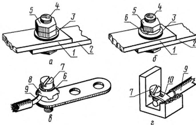
*a — с контргайкой; б — с пружинной шайбой; в — однопроволочная (многопроволочная) жила провода (кабеля) сеч. до 10 мм<sup>2</sup> с изгибанием в кольцо; г — однопроволочная (многопроволочная) жила провода (кабеля) сеч. до 10 мм<sup>2</sup> без изгибаия в кольцо*
