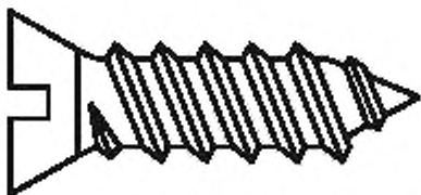
Рисунок 1 — Самонарезающий формирующий винт (3.6.10)
