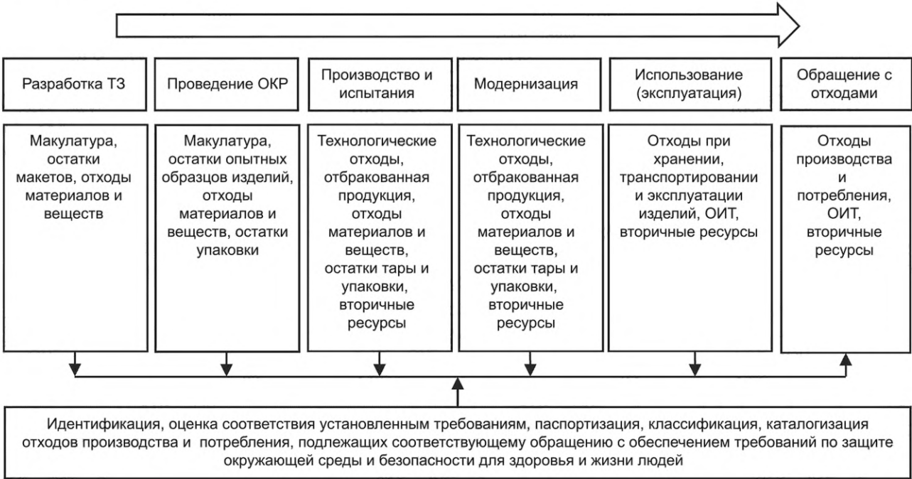
Рисунок А.1 — Схема образования на шести (из семи) стадиях жизненного цикла продукции (изделий) основных видов отходов
