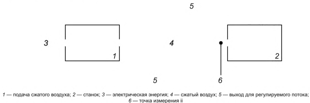
Рисунок 9 — Измерение объема сжатого воздуха на входе в станок по методу b)
