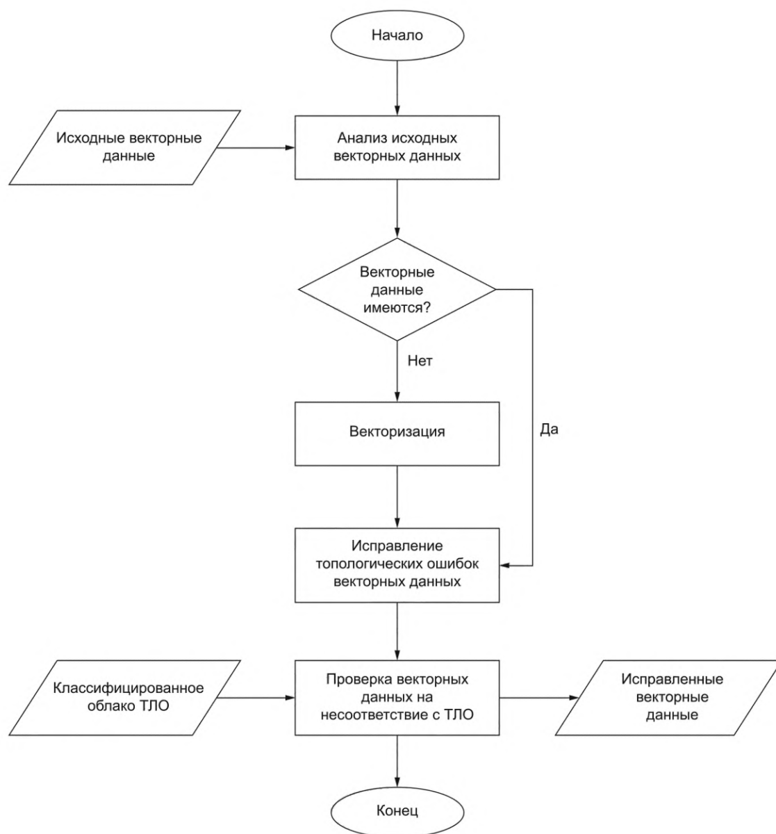
Рисунок А.7 — Подготовка векторных данных для моделирования, технологическая схема создания объектных ЦПММ
