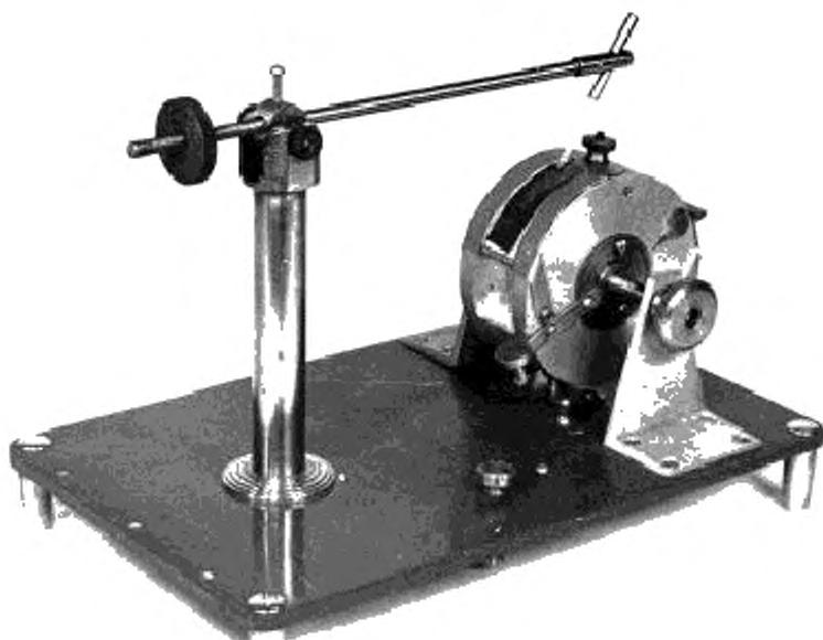
Рисунок 2 — Прибор для определения чувствительности спичек к воспламенению
