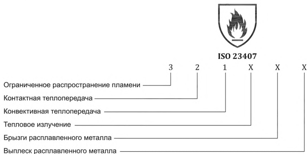
Рисунок 8 — Пример маркировки с заявленным ограниченным распространением пламени
