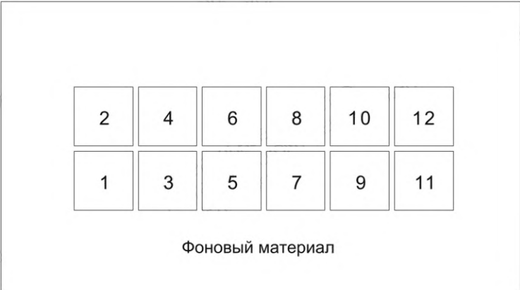
Рисунок Д.5 — Пример тест-таблицы для испытания на передачу серой шкалы
