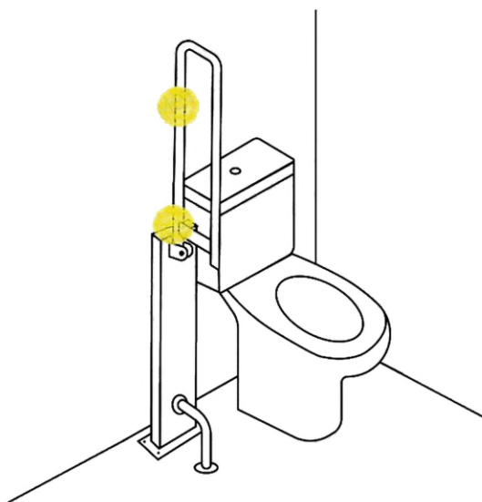
Рисунок А.18 — Откидной поручень без устройства фиксации в вертикальном положении недопустим
