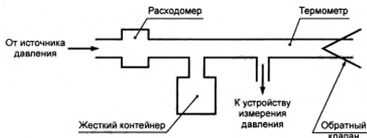
Рисунок А.3 — Расположение аппаратуры для испытания на обратный поток, проходящий через обратные клапаны
