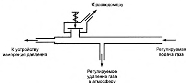
Рисунок А.2 — Расположение аппаратуры для испытания на утечку предохранительных клапанов
